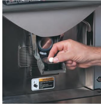
Coloque una tableta de limpieza en la cámara de elaboración.
