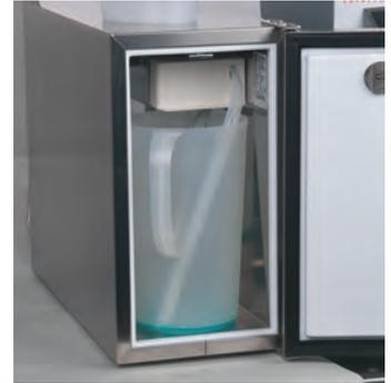
Coloque la jarra de limpieza en el gabinete, coloque las mangueras en la jarra asegurando de que ambas lleguen hasta el fondo de la jarra.
