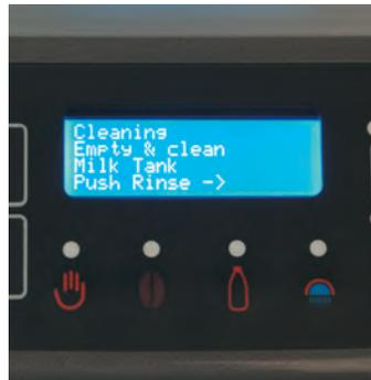
Cuando lo indique la pantalla retire la jarra de limpieza, vaciar y colocar las mangueras en la jarra.
